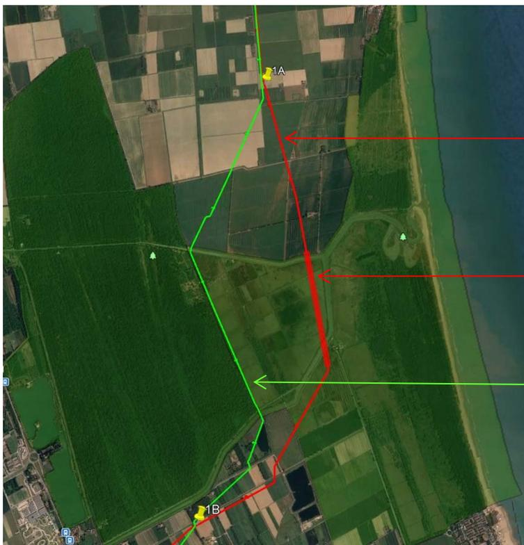
Linea in progetto, scostamento progettato per minimizzare interferenza SIC/ZPS.
