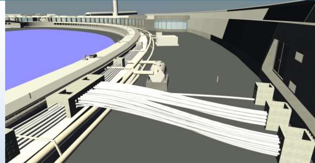
**Elementi sottoposti alla verifica delle interferenze (Clash detection)**
