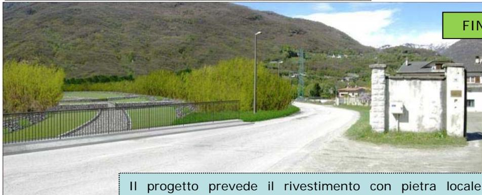
Il progetto prevede il rivestimento con pietra locale di idonea pezzatura di tutte le parti in vista dei manufatti (fondo alveo, briglie e murature di sostegno). Il consolidamento delle sponde sarà realizzato mediante scogliere di massi, intasati di terra e rinverditi con talee di salice appartenenti a specie autoctone, tipiche, quali *Salix eleagnos* e *Salix purpurea*.
